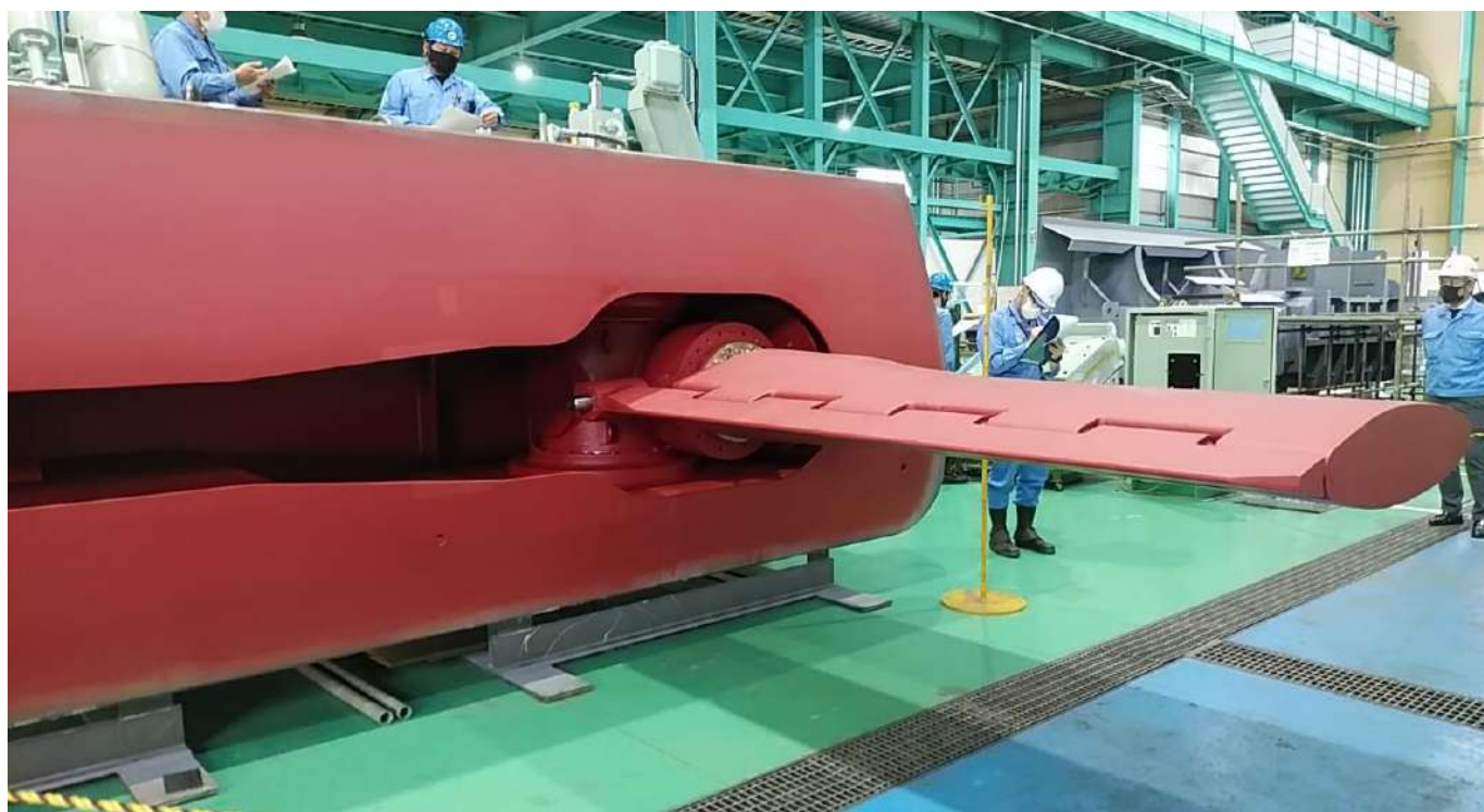
< 角度を調整することで船体の横揺れ（ローリング）を減揺します >
